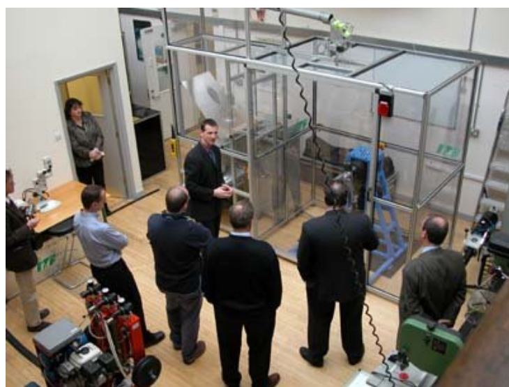
図2 ITF Technical Center のラケットのパワー測定装置
