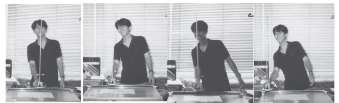
図1 人間による台車上の倒立棒の安定化制御
