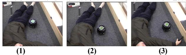
図9 実験環境Ⅲの外界（実環境）に寝転がっている人間の動きを動的障害物として認識して回避行動するロボット
