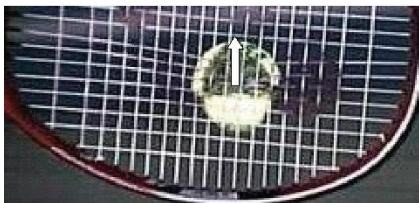
図1 スピンのメカニズム:ストリングの縦糸と横糸が滑りやすく、縦糸が横にずれ戻りやすいほどボールの食いつきが良く、横方向の復原力によりスピンがかかる。
