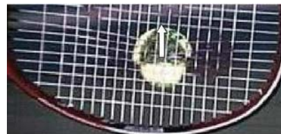
図2 横にずれたストリング縦糸が元に戻るときの復原力によるスピン
