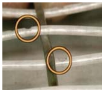
図1 ラケット使用後にストリングスの縦糸・横糸の交差点にできたノッチ
