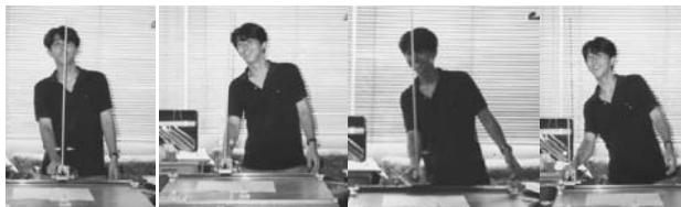
図2 人間による台車上の倒立棒の安定化制御
