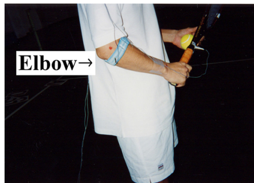
図2 肘関節とラケット・ハンドル部 に取り付けた加速度計
